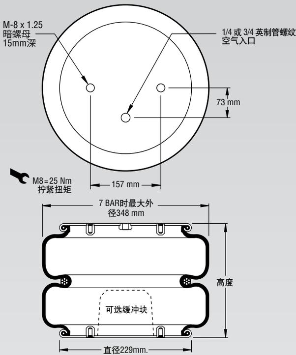
注：在最小高度下，气囊将翻到缘板平面之外。
